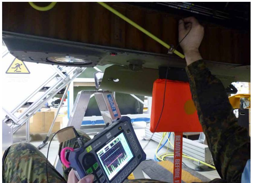
Ultraschallprüfung an einem NH90 im Rahmen einer 600 Stunden-Inspektion.
