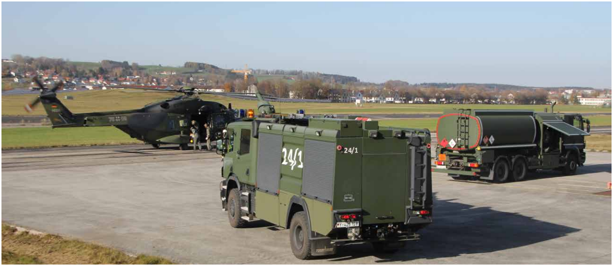
Ein „FRP“ besteht mindestens aus einem Tank- und einem Feuerlöschfahrzeug.
