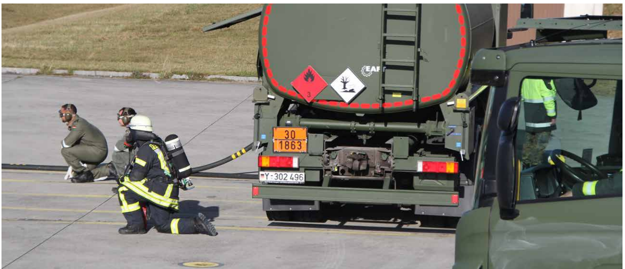
14.500 Liter Flugkraftstoff passen in das 6x4 Flugfeld-Tankfahrzeug.
