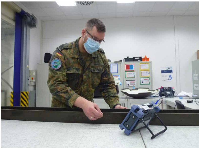
Ultraschallprüfung im Rahmen der Airbus Qualitätssicherung.
